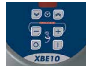
Kontrolni panel s tipkama na dodir
